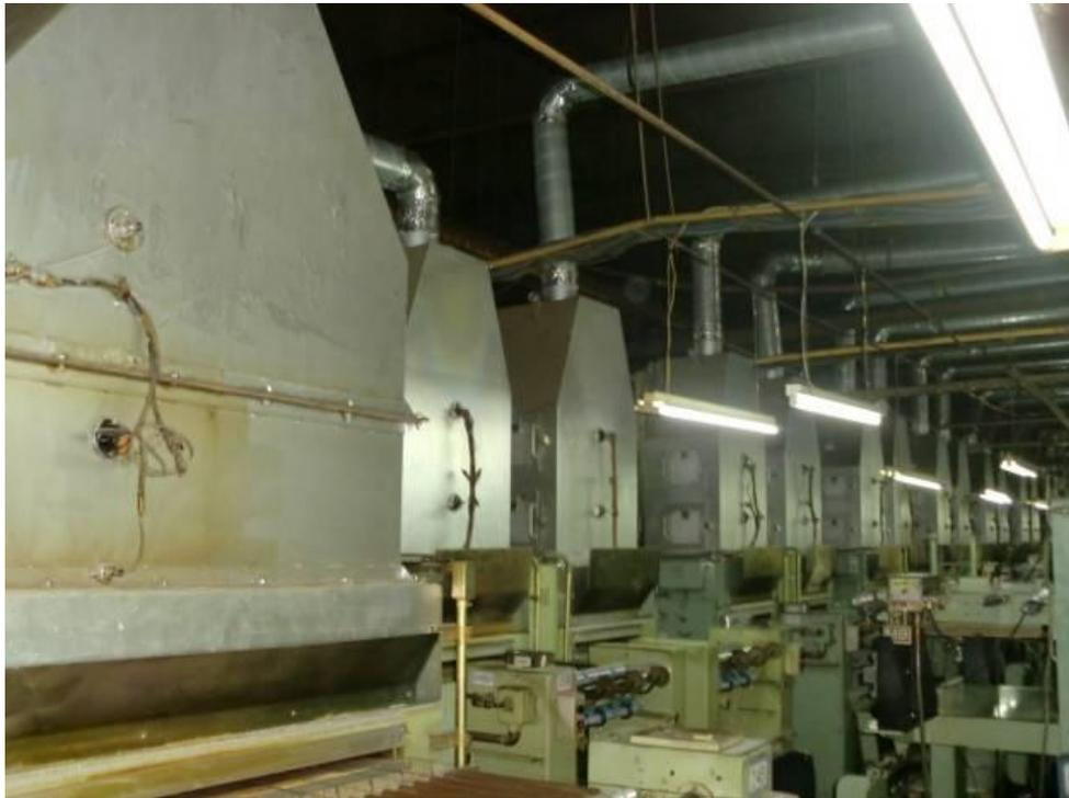
图 15: 烧付设备的废气催化燃烧设施
