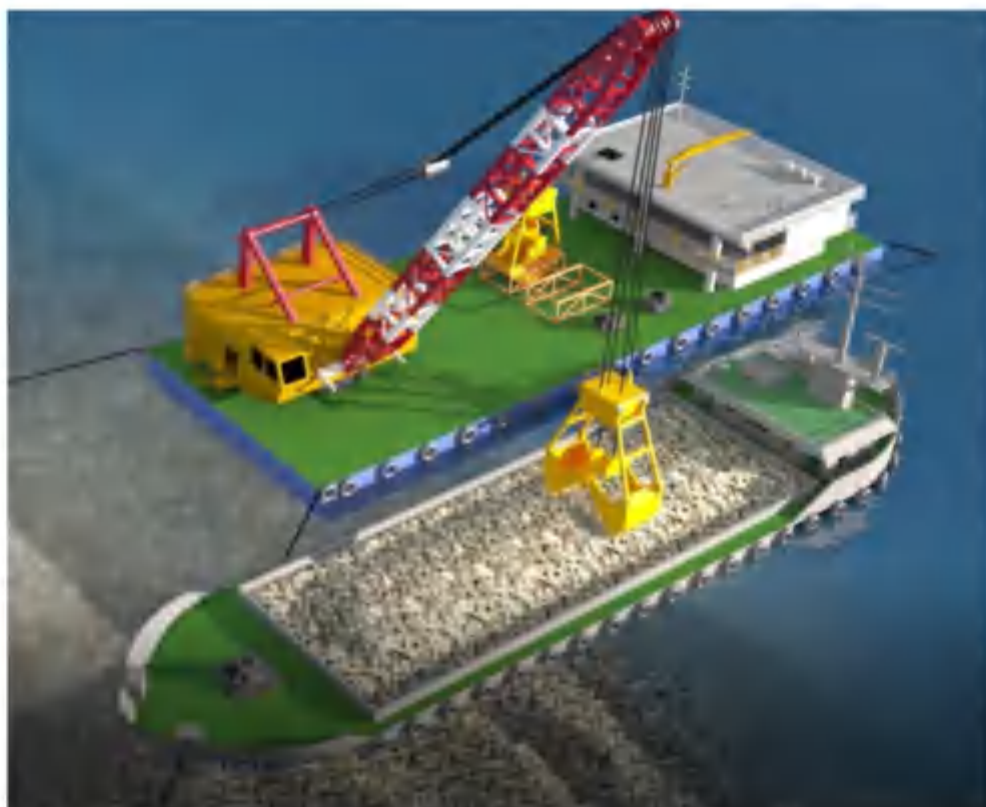
图 2.3.1-3 抓斗式挖泥船施工示意图
