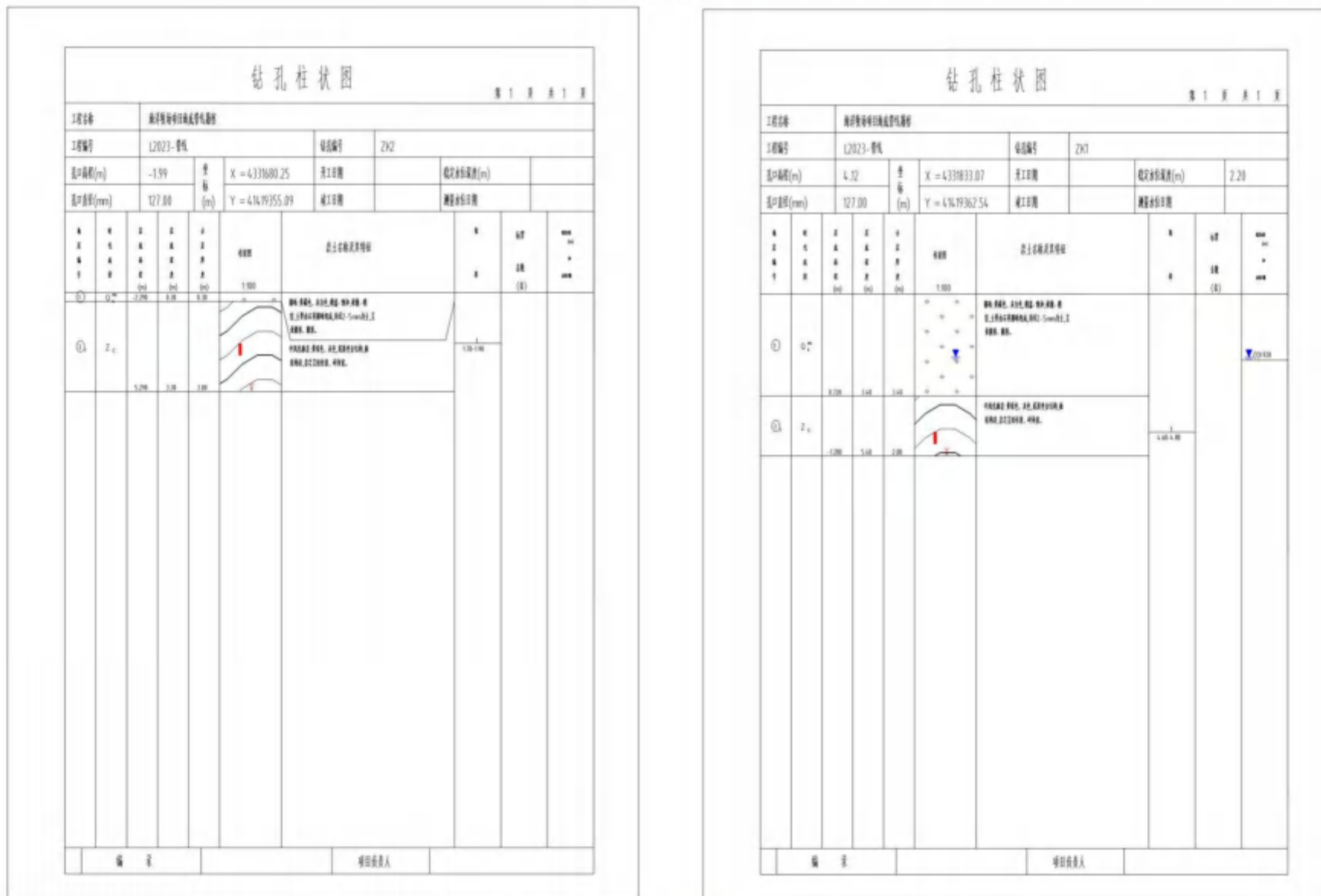
图 3.2.4-2 (c) 本项目工程钻孔柱状图 (ZK1-ZK2)
