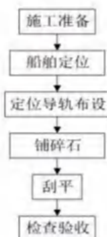
图 2.3.2-4 回填垫层施工流程
