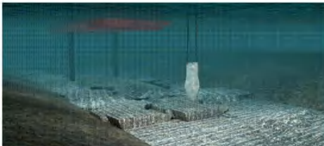
图 2.3.2-3 凿岩棒击打岩石示意图
